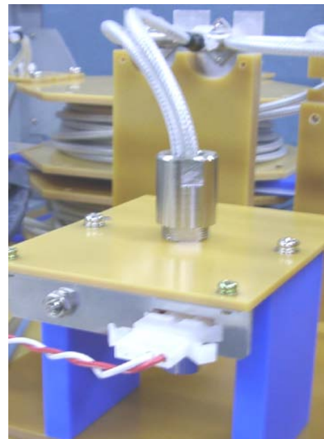
図 8 水銀リレー取付状態
